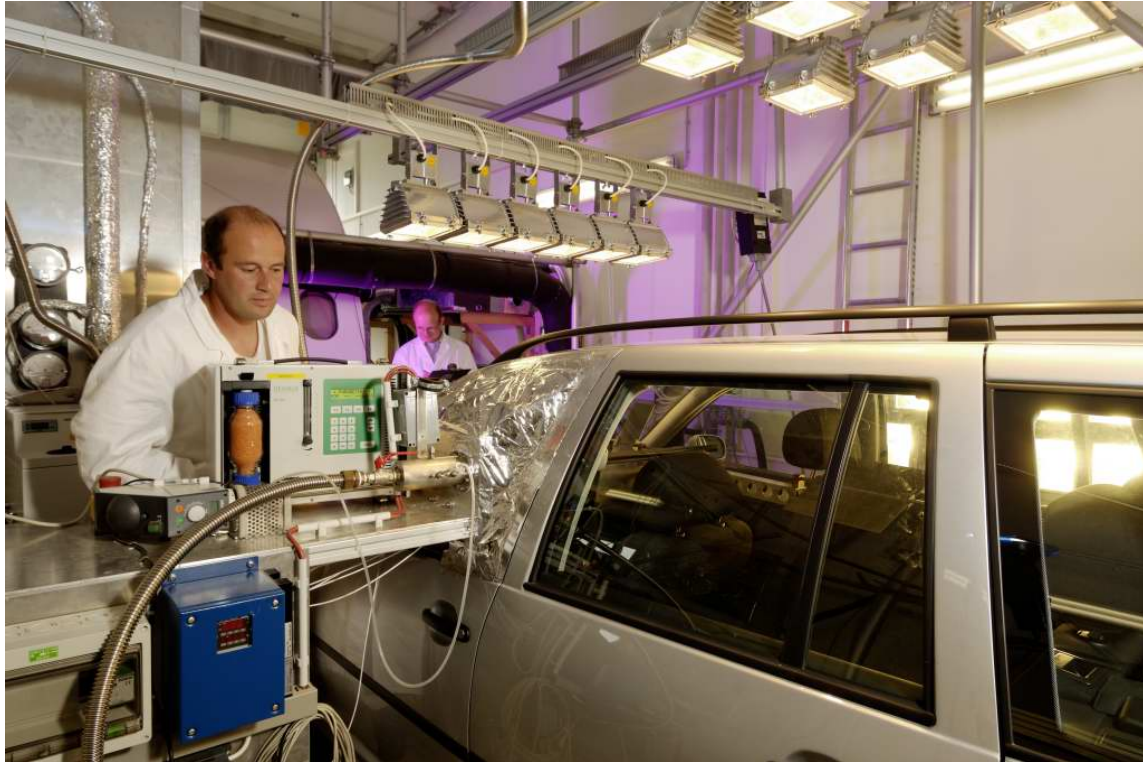
Bild 6: Untersuchung an einem Fahrzeug im Fahrzeuginnenraum-emissionsprüfstand
