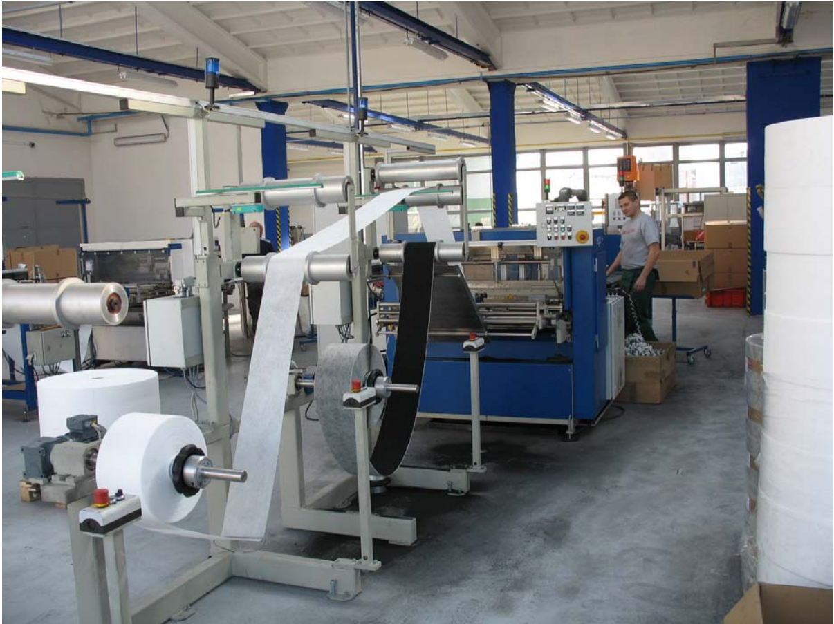
Bild 1: Kombifilterfertigung bei Mann+Hummel. Ein aktivkohlebeschichtetes Trägervlies wird mit einem Partikelfiltervlies plissiert.
